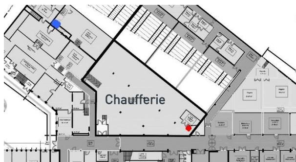
En bleu : caisson d'amenée d'air neuf En rouge : ventilateur d'extraction
